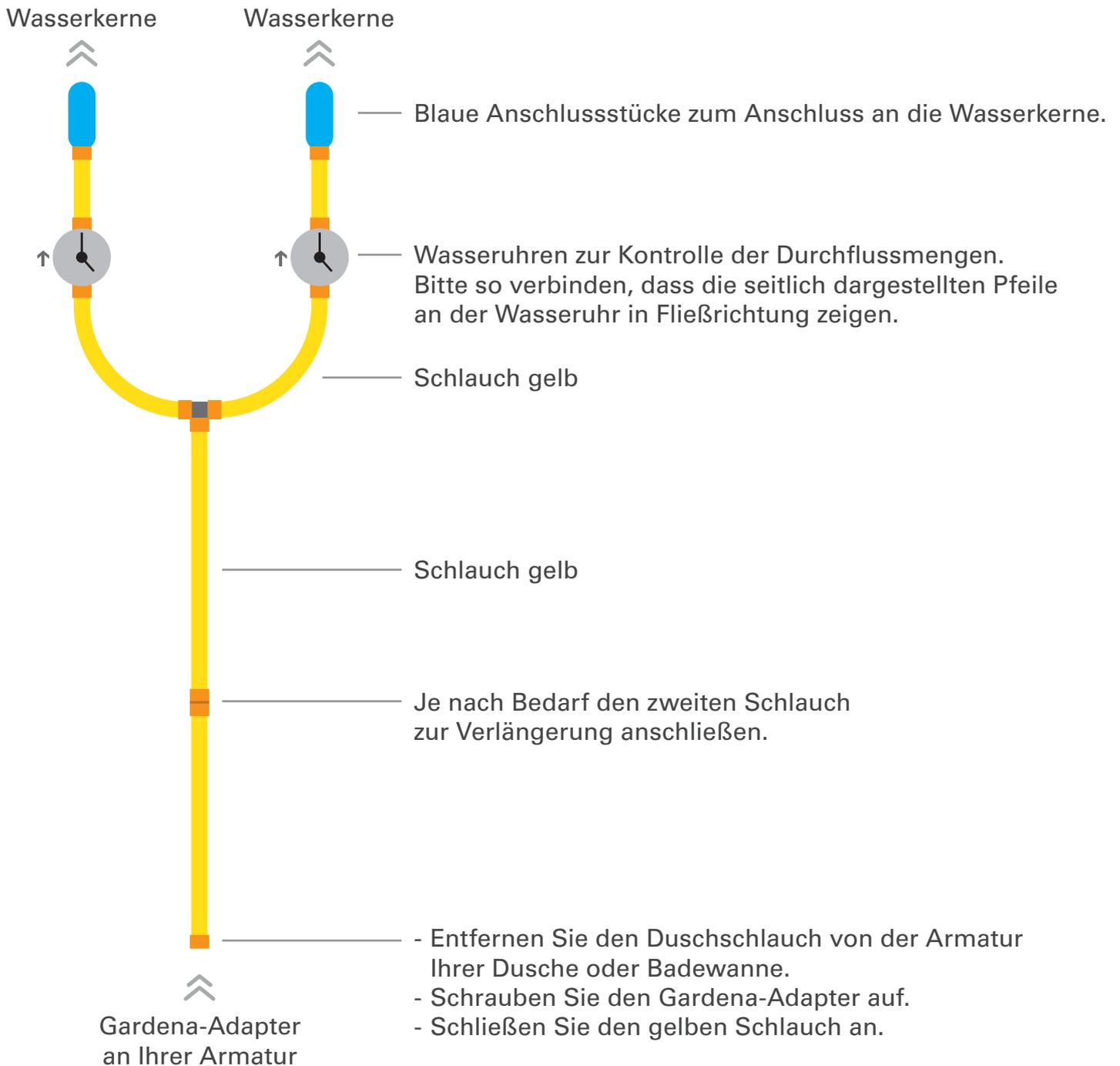
Prüfen Sie die Steckverbindungen bei Verwendung der Schlauchverlängerung auf Dichtigkeit.
