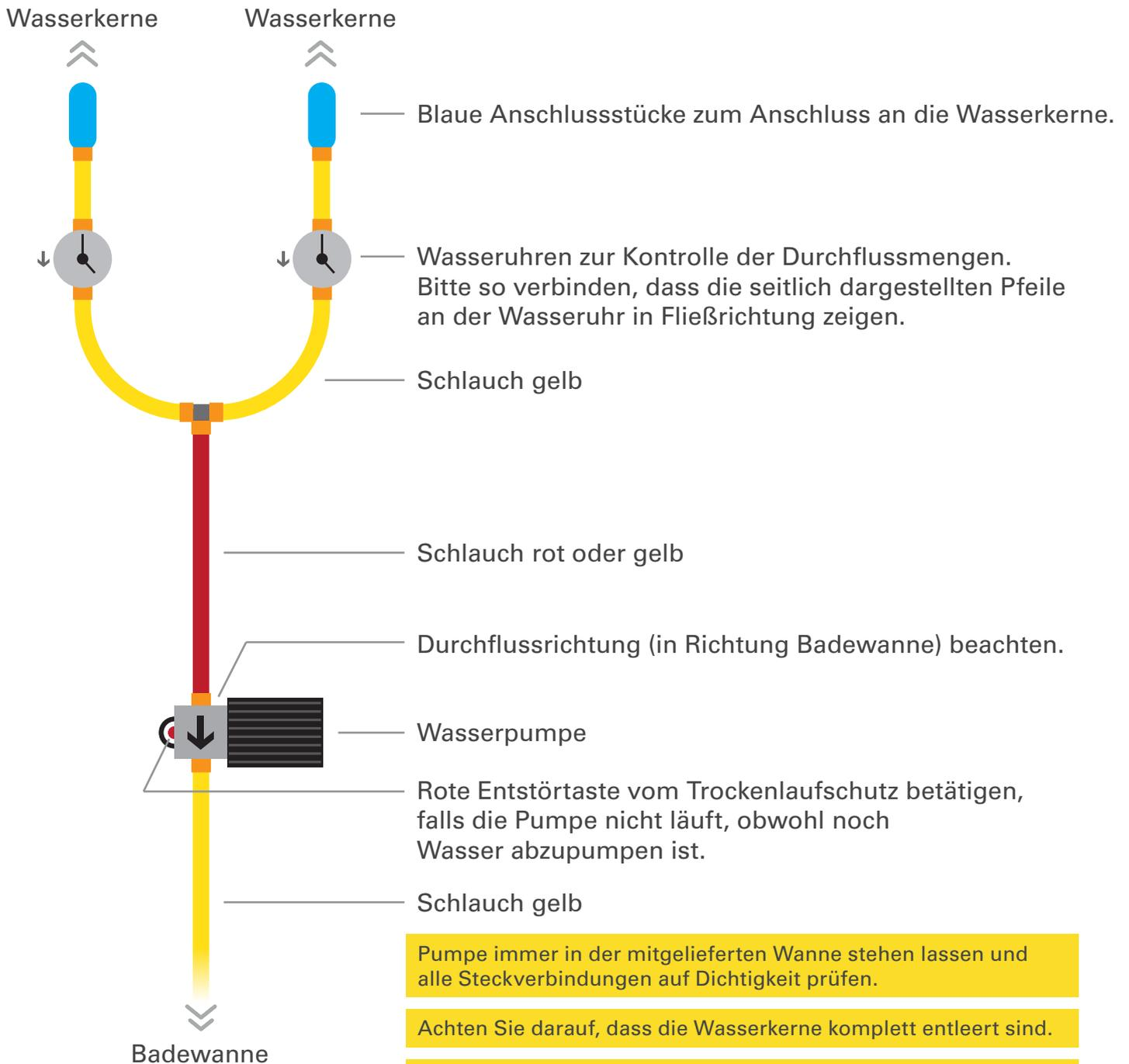
Pumpe immer in der mitgelieferten Wanne stehen lassen und alle Steckverbindungen auf Dichtigkeit prüfen.
